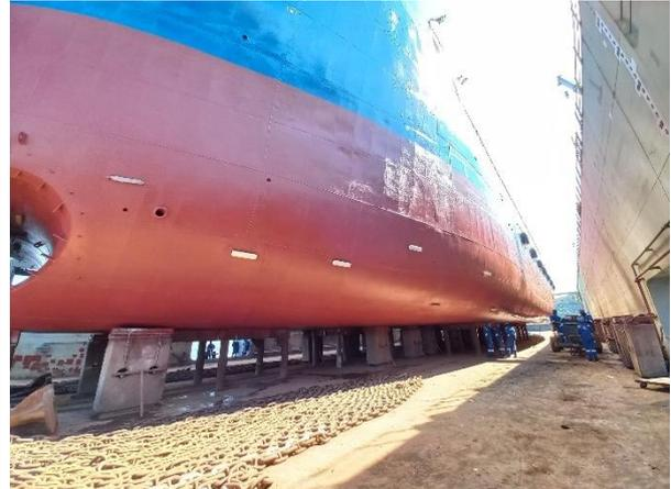
Foto 2 –Fundo vertical à bombordo da embarcação UP Água Marinha limpo e pintado.
