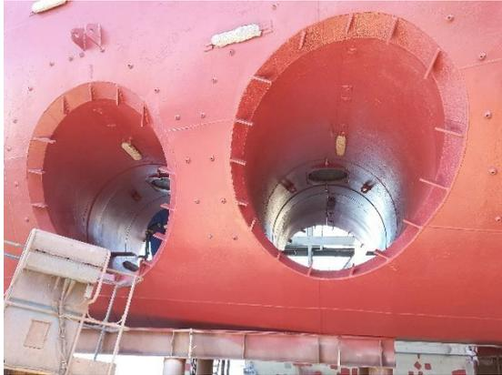
Foto 1 – Detalhe do *Bow thruster* à bombordo da embarcação UP Água Marinha limpo e pintado.
