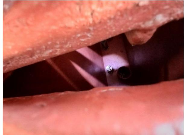
Foto 6 – Interior da caixa de mar próximo à proa da embarcação UP Água Marinha limpa e pintada.
