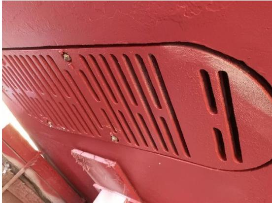
Foto 5 – Caixa de mar próximo à proa da embarcação UP Água Marinha limpa e pintada.
