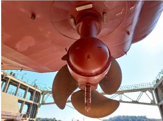
**Foto 9 - Propulsor de popa à bombordo da embarcação UP Água Marinha limpo e pintado.**
