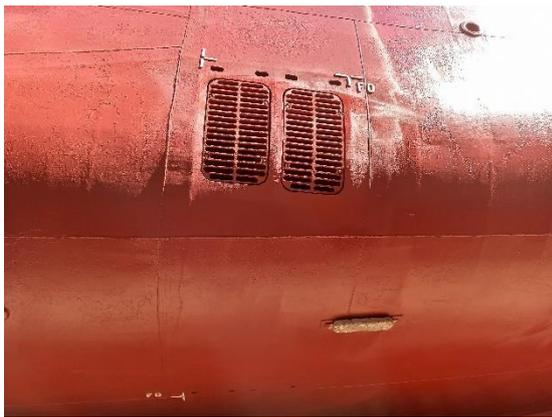
Foto 7 – Caixa de mar a bombordo da embarcação UP Água Marinha limpa e pintada.
