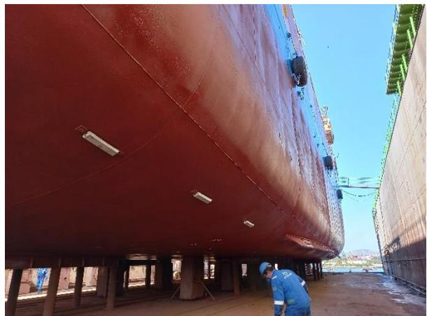
Foto 4 – Fundo do casco à boreste da embarcação UP Água Marinha limpo e pintado.
